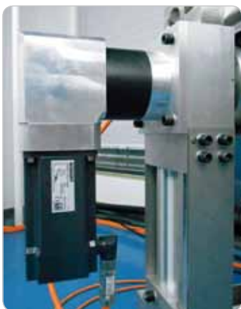
Obr. 1 Pri pripájaní servomotorov AM8000 je potrebný len jeden kábel, pretože One Cable Technology (OTC) v ňom kombinuje napájanie a spätnú väzbu
