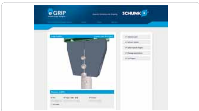
Obr. Po nahratí súborov STEP alebo STL patentovaný webový nástroj automaticky generuje optimálne 3D kontúry uchopovacích prstov
