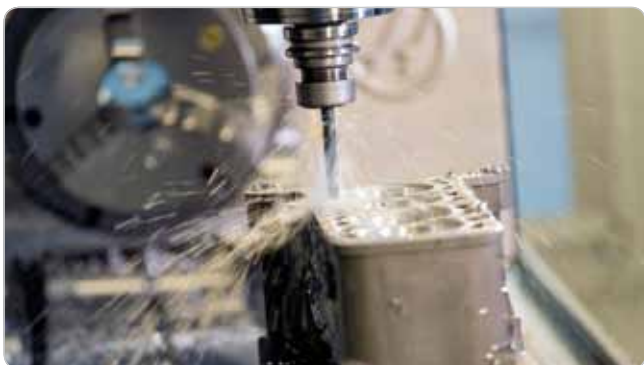
Obr. 2 Jeden z troch CNC strojov Haas vo firme. VF-5 pracuje s 10 000 ot/min, zatiaľ čo VF-2 a VF-6 pracujú s 7500 ot/min. Dva z týchto strojov majú navyše 4-osí otočný stôl Haas
